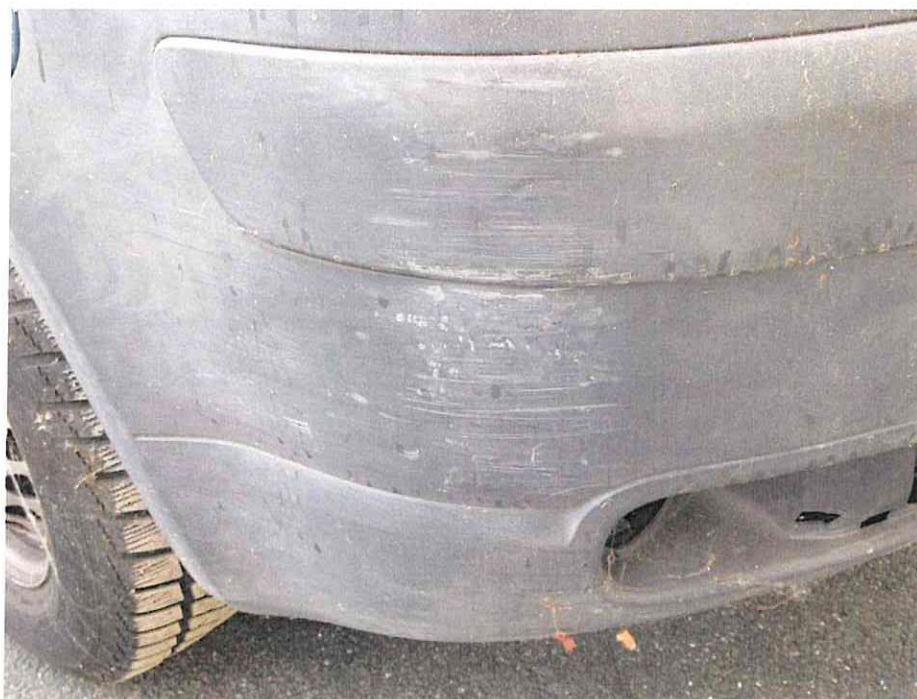
Bild 7 : Stoßfänger vorn verschrammt
