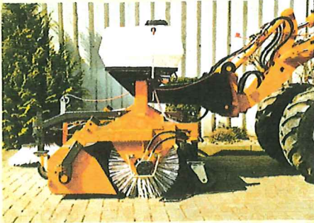
bema 20 Komplettausstattung (Schnellwechselanbau Hoflader, Wassersprüheinrichtung 240 ltr., hydr. Seitenkehrbesen, Schwerlastlaufräder)
