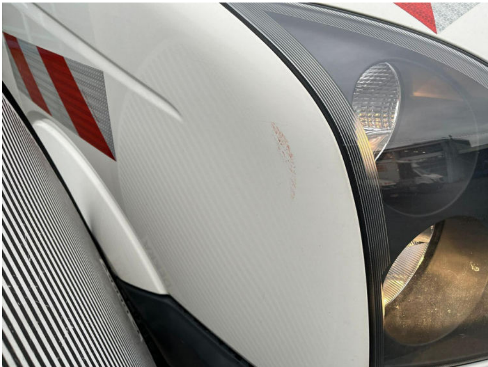
Bild 12 : Kotflügel rechts verschrammt
