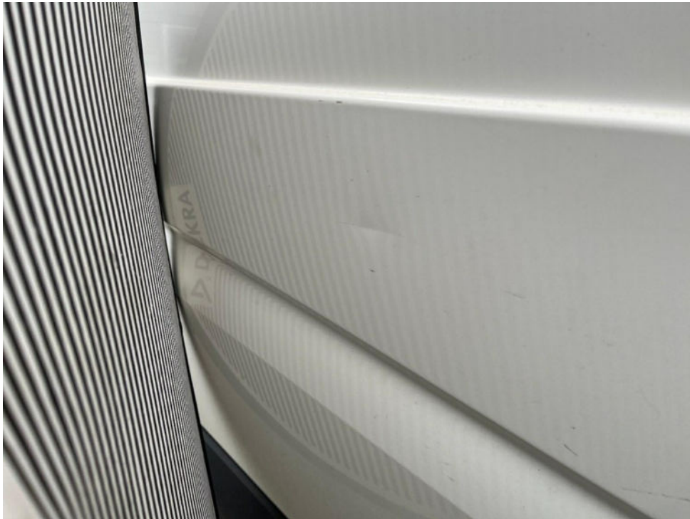
Bild 21 : Schiebetür rechts verschrammt und verformt
