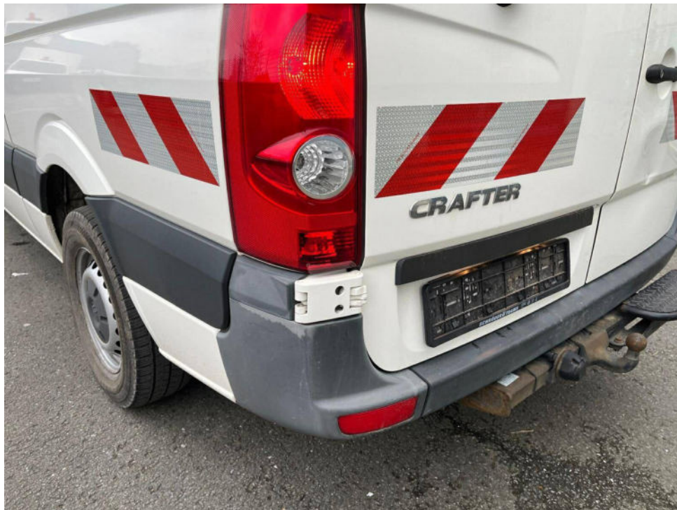
Bild 17 : Stoßfänger hinten verschrammt
