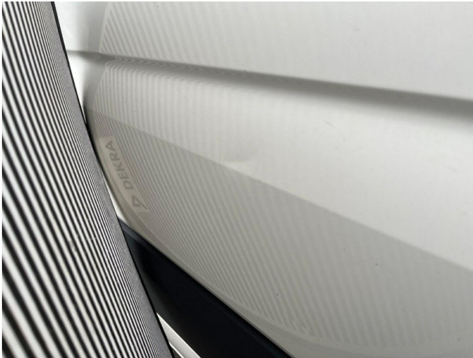
Bild 15 : Schiebetür links verschrammt und eingedellt. Oberhalb streifend verschrammt und verformt.
