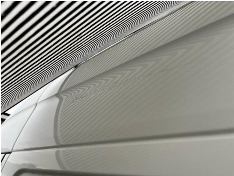
Bild 14 : Schiebetür links verschrammt und eingedellt. Oberhalb streifend verschrammt und verformt.
