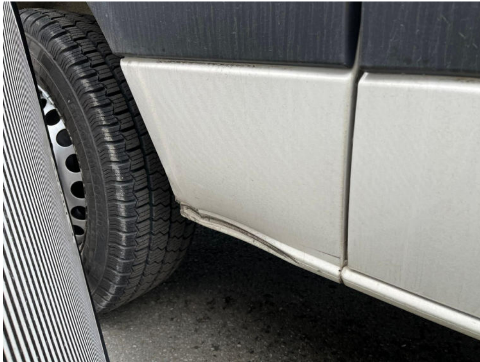
Bild 19 : Seitenwand hinten rechts verformt
