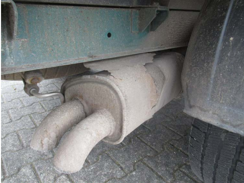
Bild 21 : Endschalldämpfer st. korrodiert
