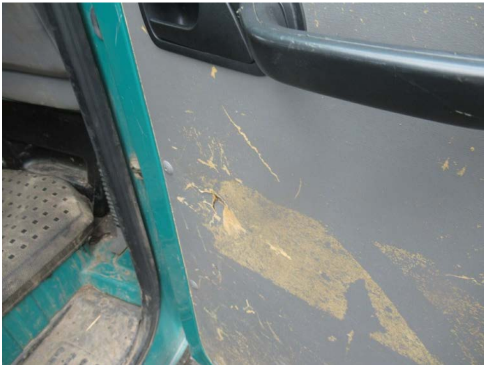
Bild 10 : Türverkleidung hr gerissen
