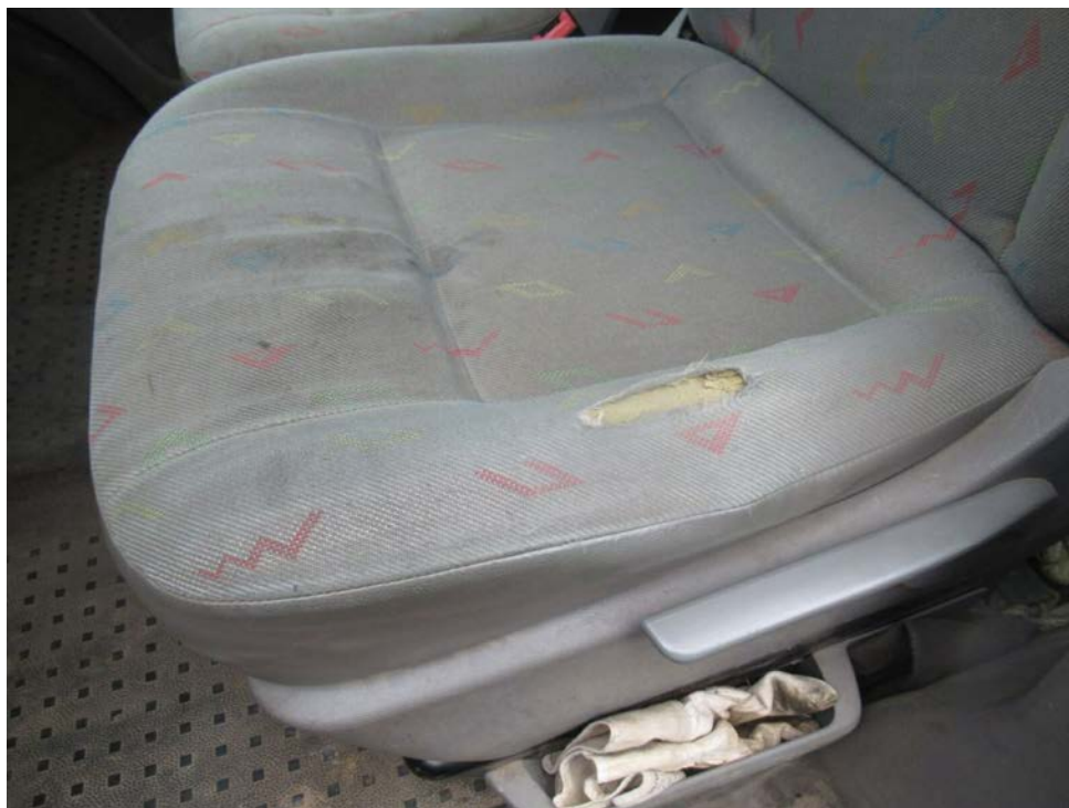
Bild 8 : Fahrersitz linksseitig aufgerissen/verschlissen
