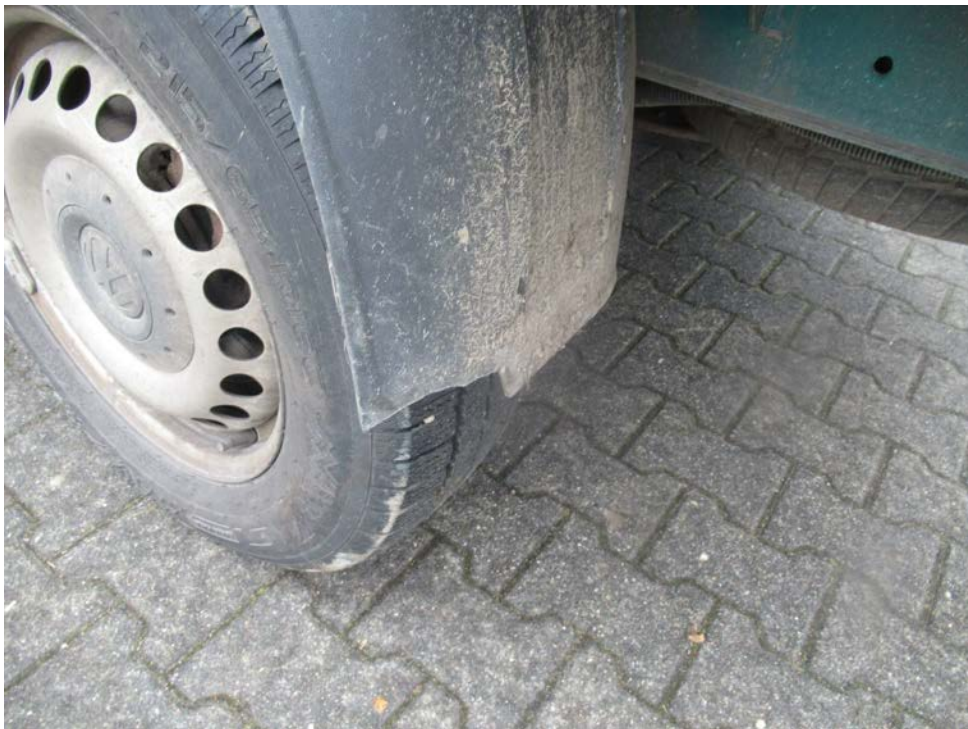
Bild 14 : Kotflügel hl tw abgebrochen
