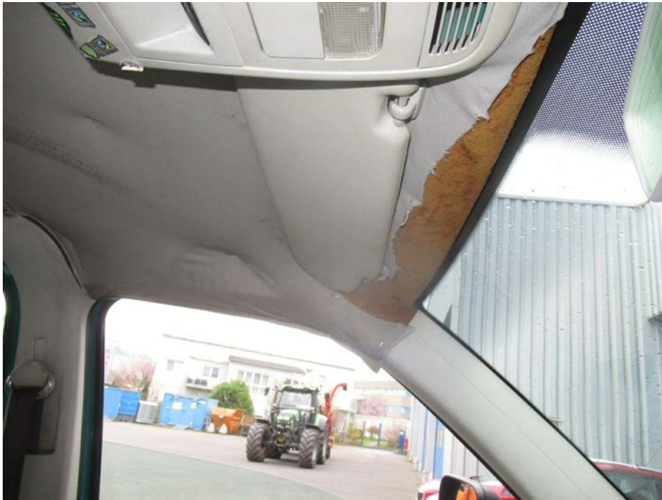
Bild 9 : Dachhimmel tw abgerissen
