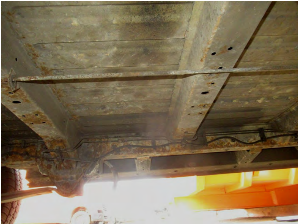
Bild 14 : Boden- u. Rahmenteile Rostbefall
