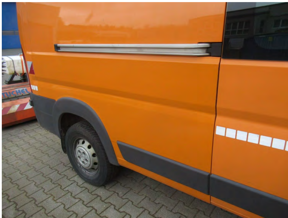
Bild 17 : Seitenwand hr nachlackiert
