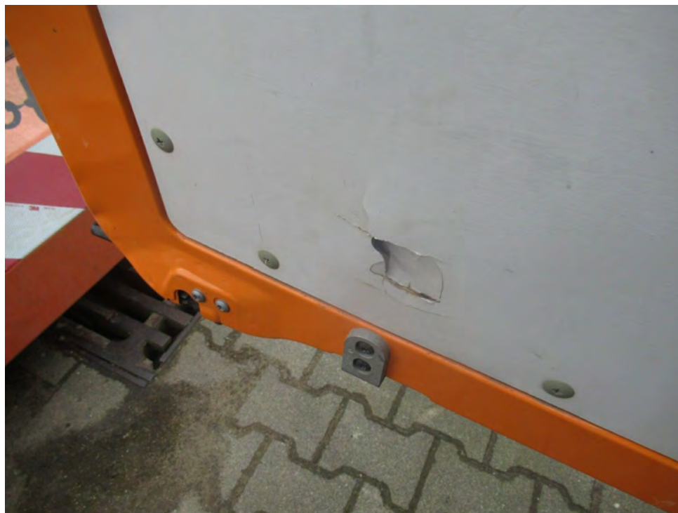
Bild 11 : Tür hl unten deformiert, Türverkleidung gerissen
