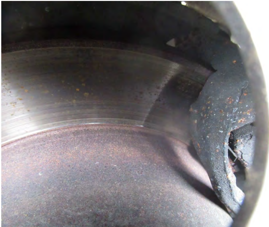
Bild 18 : Bremsklötze Hinterachse verschlissen
