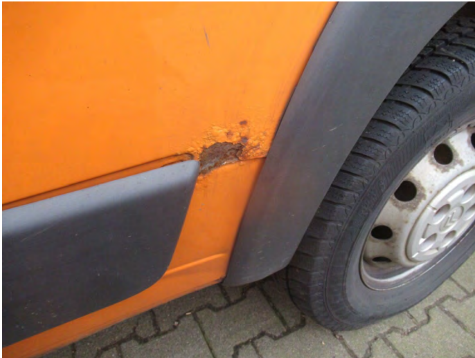
Bild 12 : Seitenwand hl deformiert u. Rostbefall
