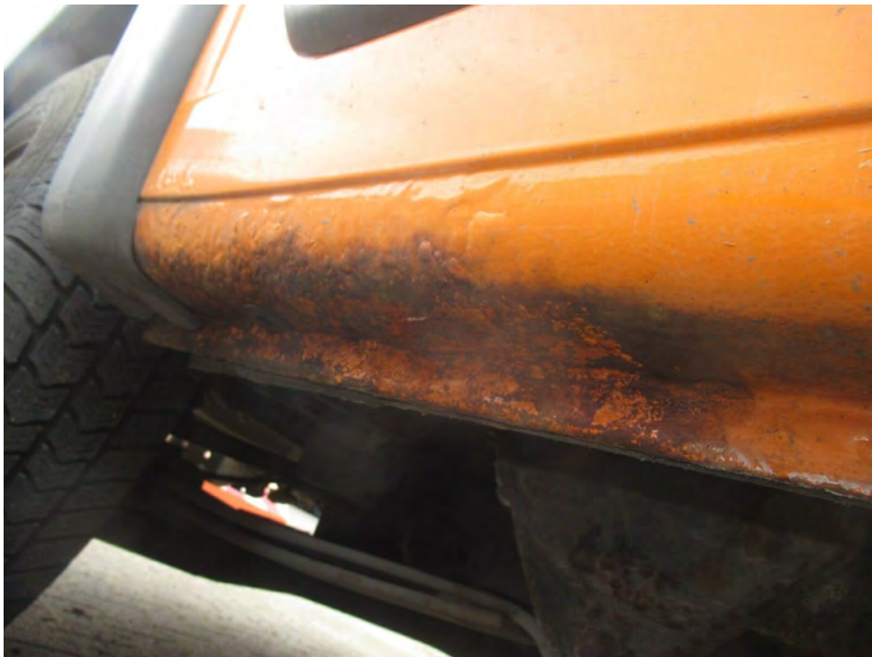
Bild 13 : Schweller hr st. Rostbefall
