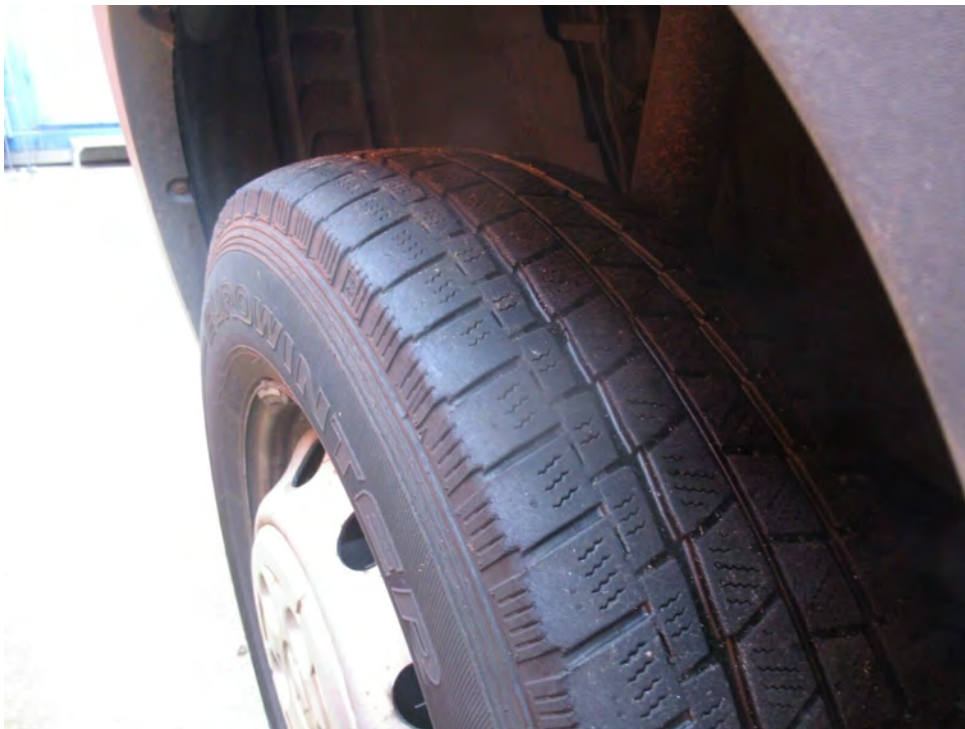
Bild 19 : Reifenverschleiß Vorderachse einseitig
