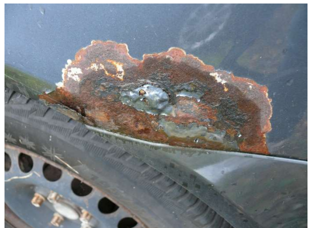
Rost hinten links, Nahaufnahme
