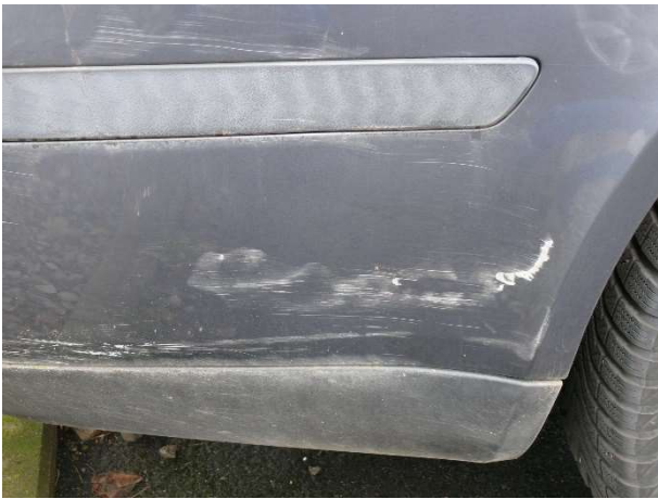
Schaden, Radlauf/Heck, Nahaufnahme
