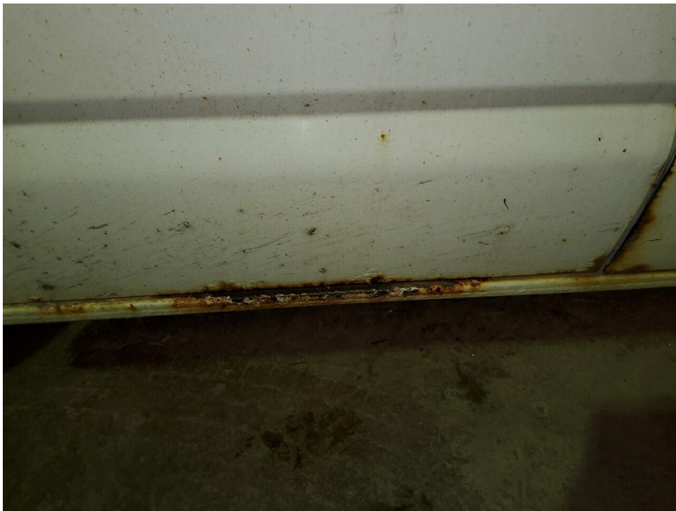
Bild 8 : Rostansatz im Schwellerbereich
