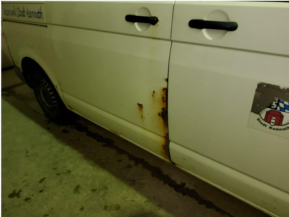
Bild 9 : Rostansatz an Karosserie
