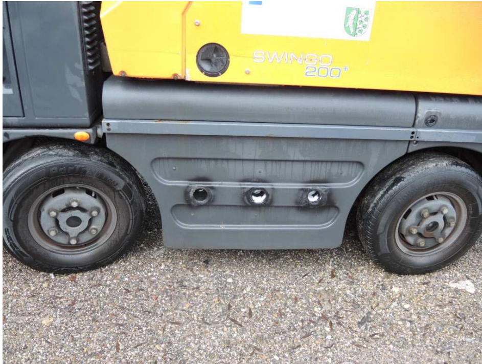
Bild 7 Tank linksseitig behelfsmäßig instandgesetzt
