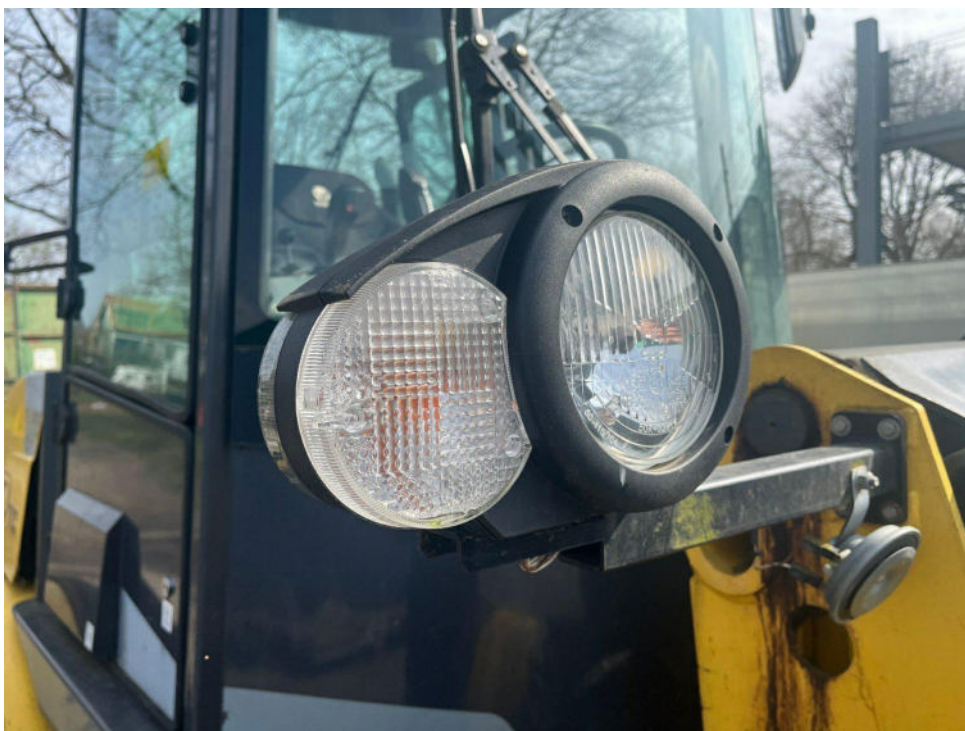
Bild 18 : Feuchtigkeit in den Scheinwerfern rechts und links vorn
