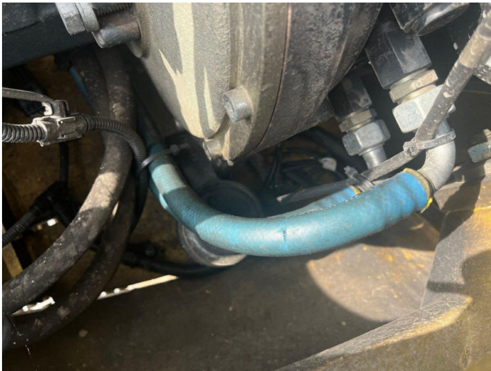
Bild 12 : Hydraulikleitung an der Hydraulikpumpe rissig
