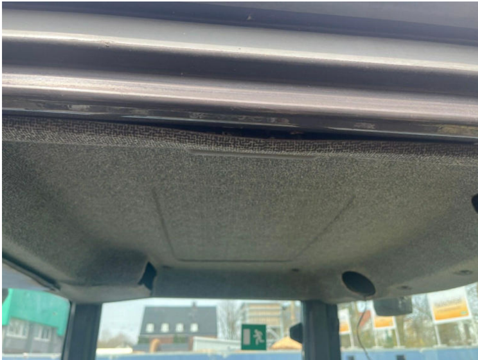
Bild 17 : Innenraum Lautsprecher + Radio fehlen Dachhimmel hängt teilweise herunter
