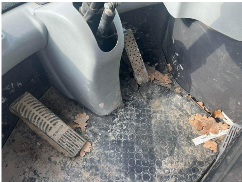
Bild 16 : Gaspedal hängt Fussbodenbelag gerissen
