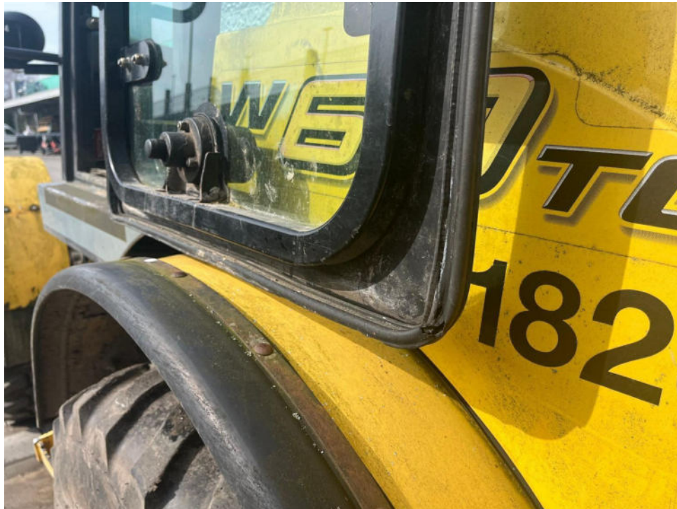
Bild 15 : Türgummidichtung Tür links gerissen
