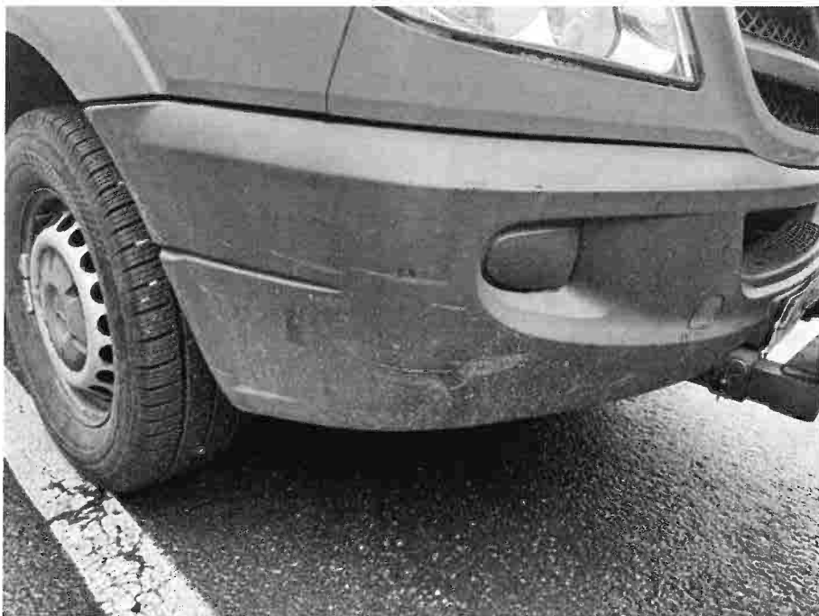
Bild 12: Altschaden: Stoßfänger vorne verschürt
