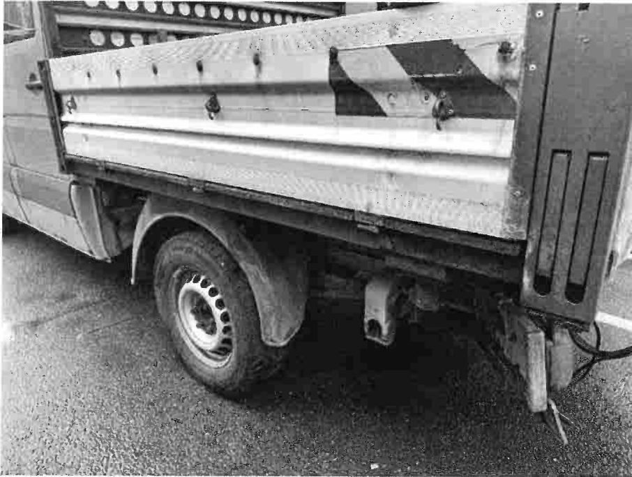
Bild 15: Altschaden: Pritsche korrodiert
