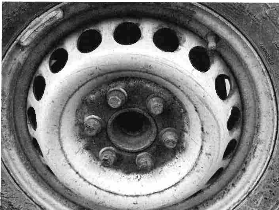
Bild 10: Felge hinten links verschürft
