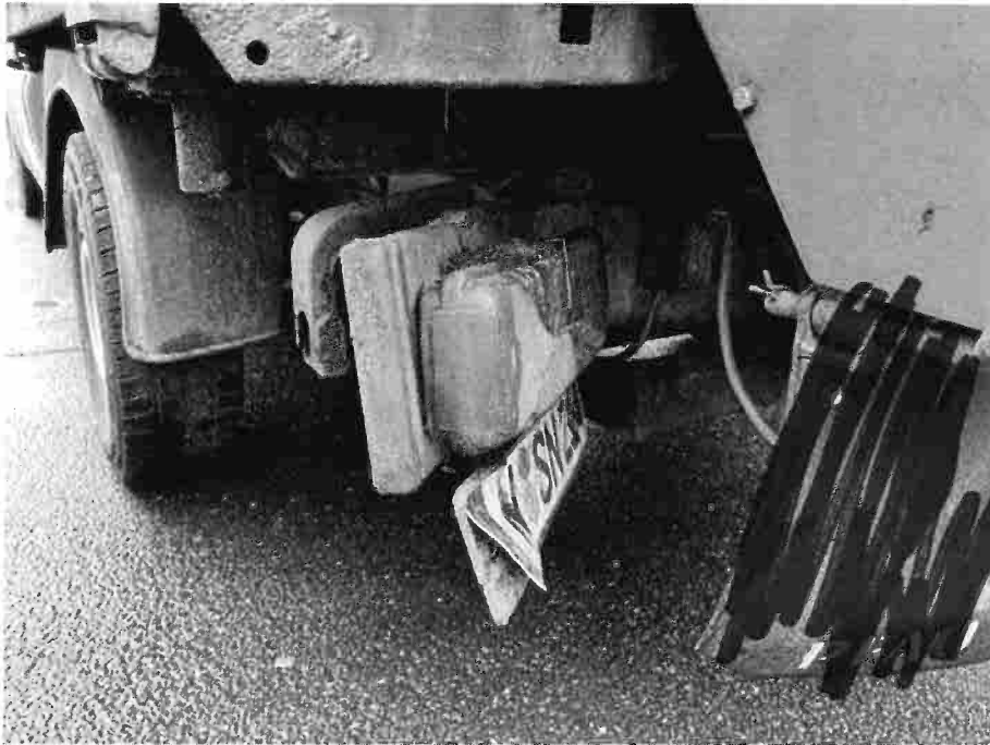
Bild 11: Abschlussblech hinten deformiert
