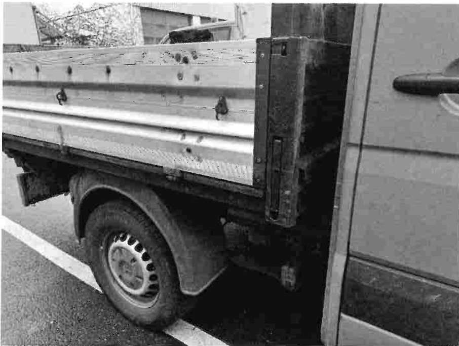
Bild 14: Altschaden: Pritsche korrodiert
