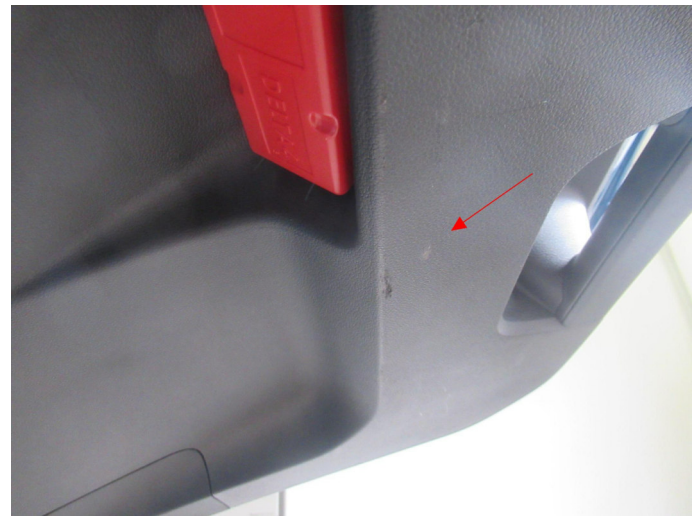
Bild 2: Innen, Verkleidung Heckklappe, verschrammt, erneuern
