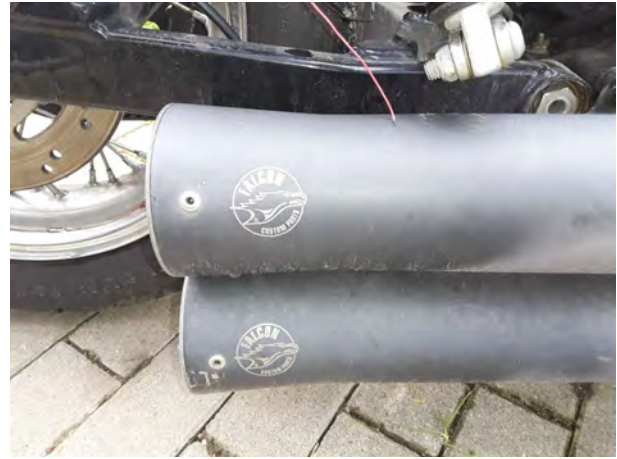
Beschädigung 11: Abgasanlage: Abgasanlage (Beschädigt ... - abweichend Auslieferungszustand - erneuern
