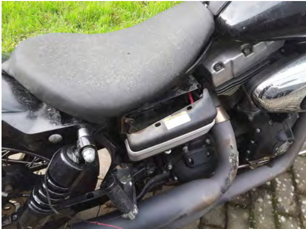
Beschädigung 4: elektrisches System: Batterie - fehlt - erneuern
