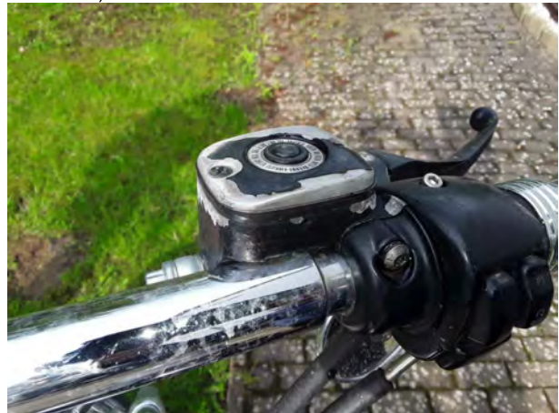
Beschädigung 3: Sonstiges: Sonstiges (Bremshebel) - Lackmangel - Smart Repair
