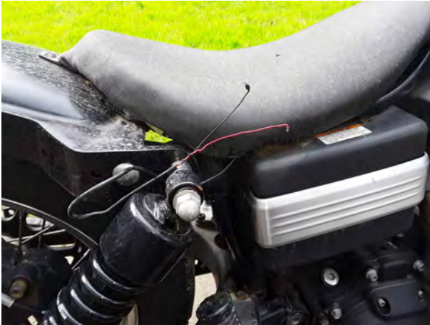
Beschädigung 1: Sonstiges: Sonstiges (Tomtom Halterungen/ Kabel lose) - ohne Funktion - instandsetzen
