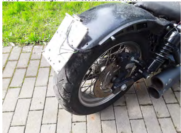
Beschädigung 7: Sonstiges: Sonstiges (Kennzeichenhalter) - abweichend Auslieferungszustand - instandsetzen
