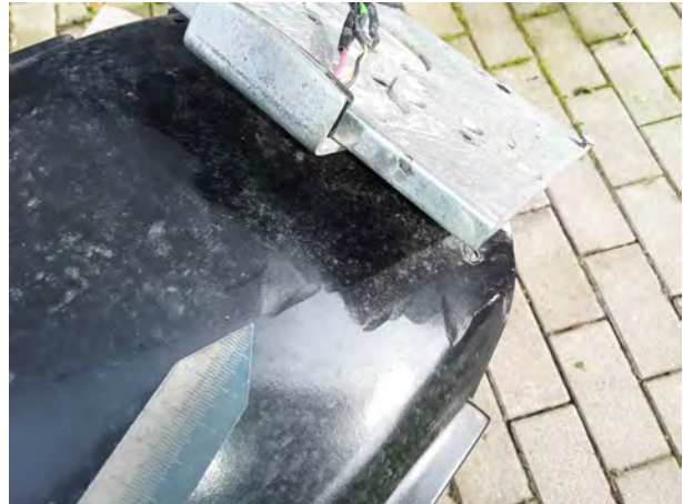
Beschädigung 6: Sonstiges: Sonstiges (Spritzschutz am Heck) - Lackmangel - instandsetzen und lackieren
