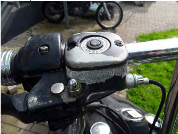
Beschädigung 3: Sonstiges: Sonstiges (Bremshebel) - Lackmangel - Smart Repair
