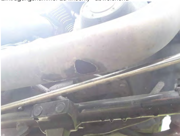
Beschädigung 11: Abgasanlage: Abgasanlage (Beschädigt u.) - abweichend Auslieferungszustand - erneuern
