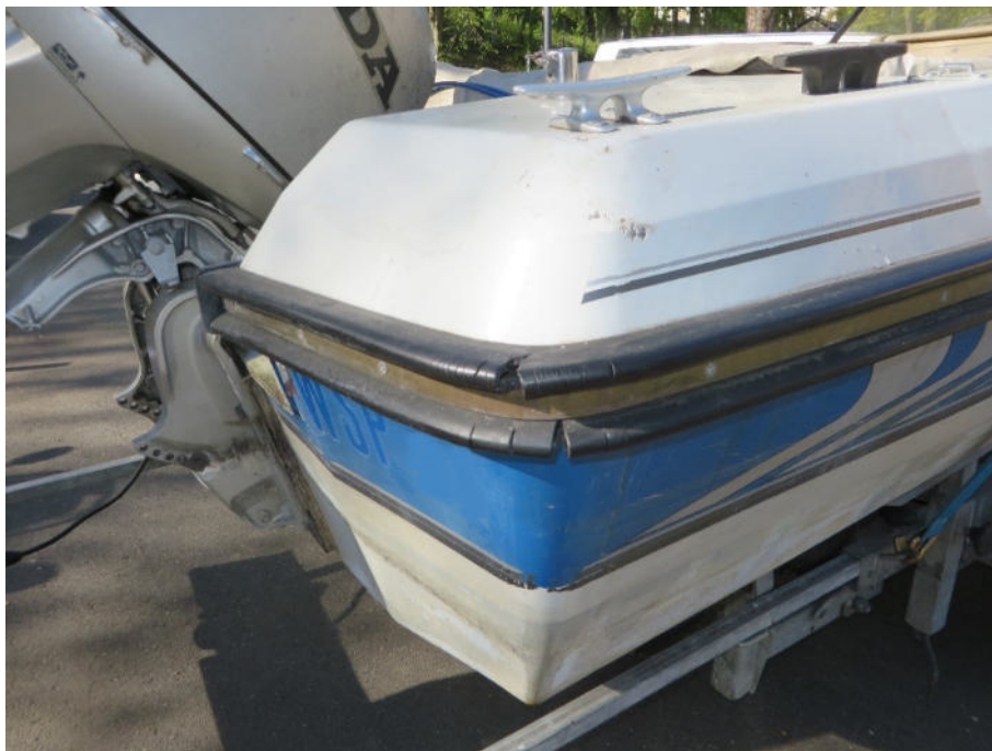
Heck Steuerbord, Beschädigungen am Rumpf und an den Scheuerleisten
