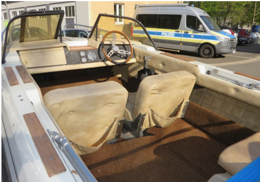
Deck, Sitzbereich, Beschädigungen und Verschmutzungen an Verkleidungen, Steuerrad, Armaturenbrett und Sitzen
