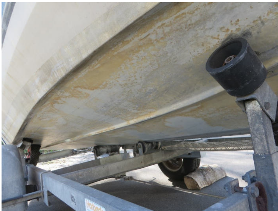
Rumpf Steuerbord, Beschädigungen am Unterwasserschiff
