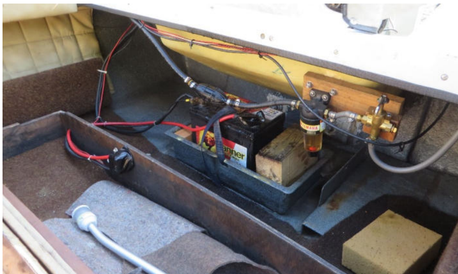
Deck hinten, Batteriebefestigung und Kraftstoffleitungen
