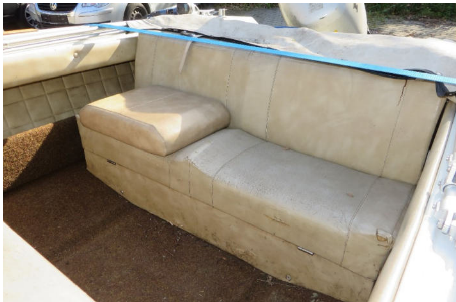
Deck hinten, Sitzbereich, Beschädigungen und Verschmutzungen an Verkleidungen und Sitzbank
