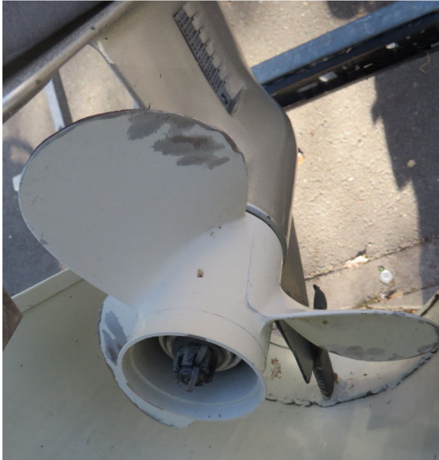
Antriebs-/ Propellereinheit, Beschädigungen an Schaft und Propeller
