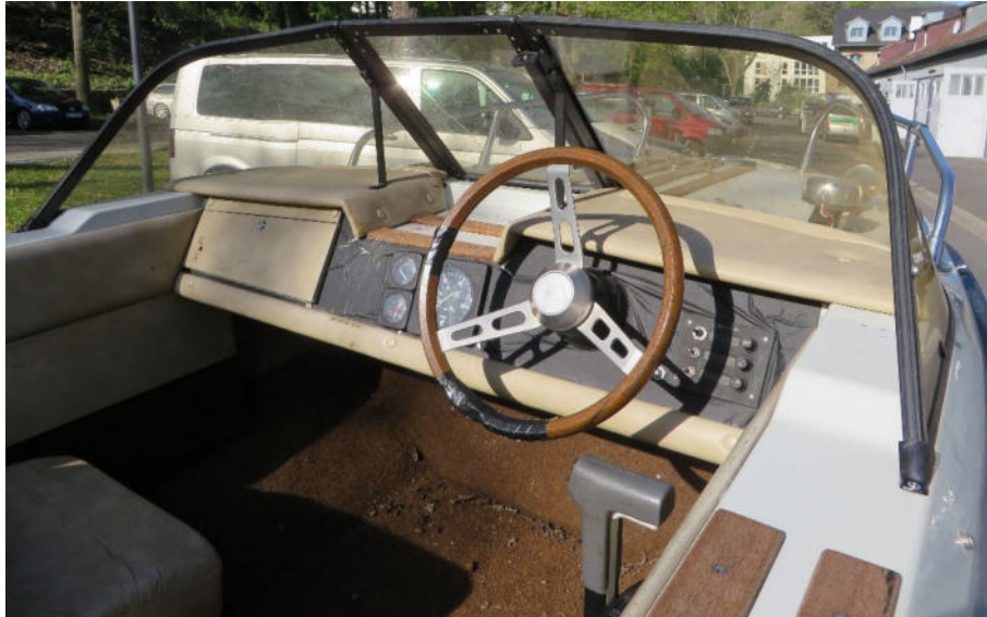
Deck vorne, Cockpit, Beschädigungen und Verschmutzungen an Verkleidungen, Steuerrad und Armaturenbrett
