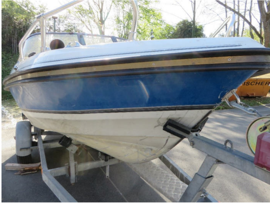
Bug Steuerbord, Beschädigungen am Rumpf
