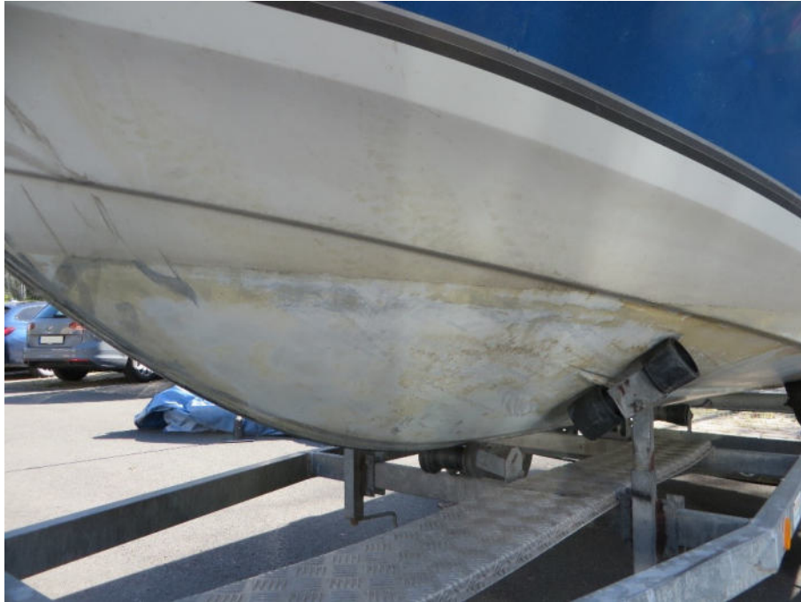
Rumpf Backbord, Beschädigungen am Unterwasserschiff
