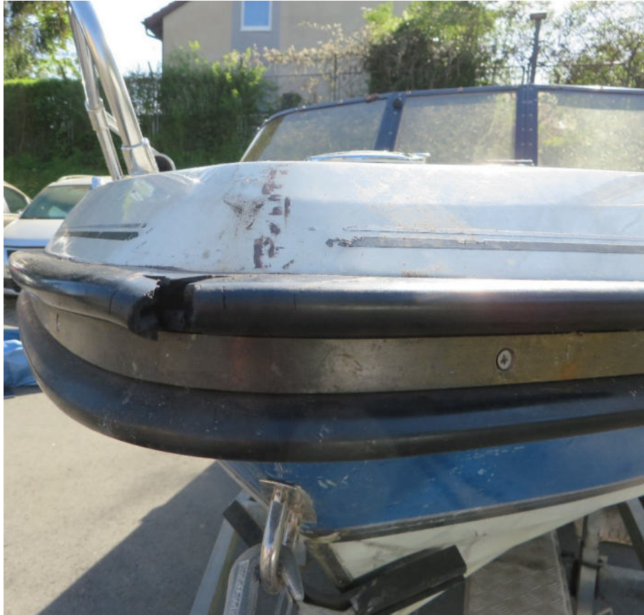
Bug, Beschädigungen am Rumpf und an der Scheuerleiste
