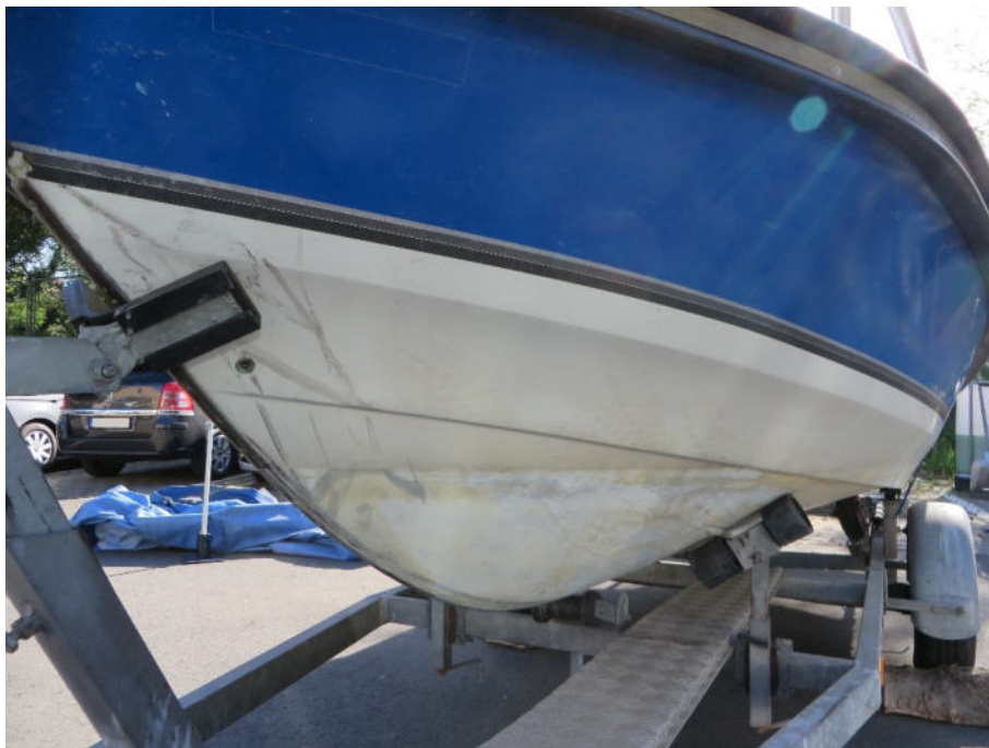
Bug Backbord, Beschädigungen am Rumpf
