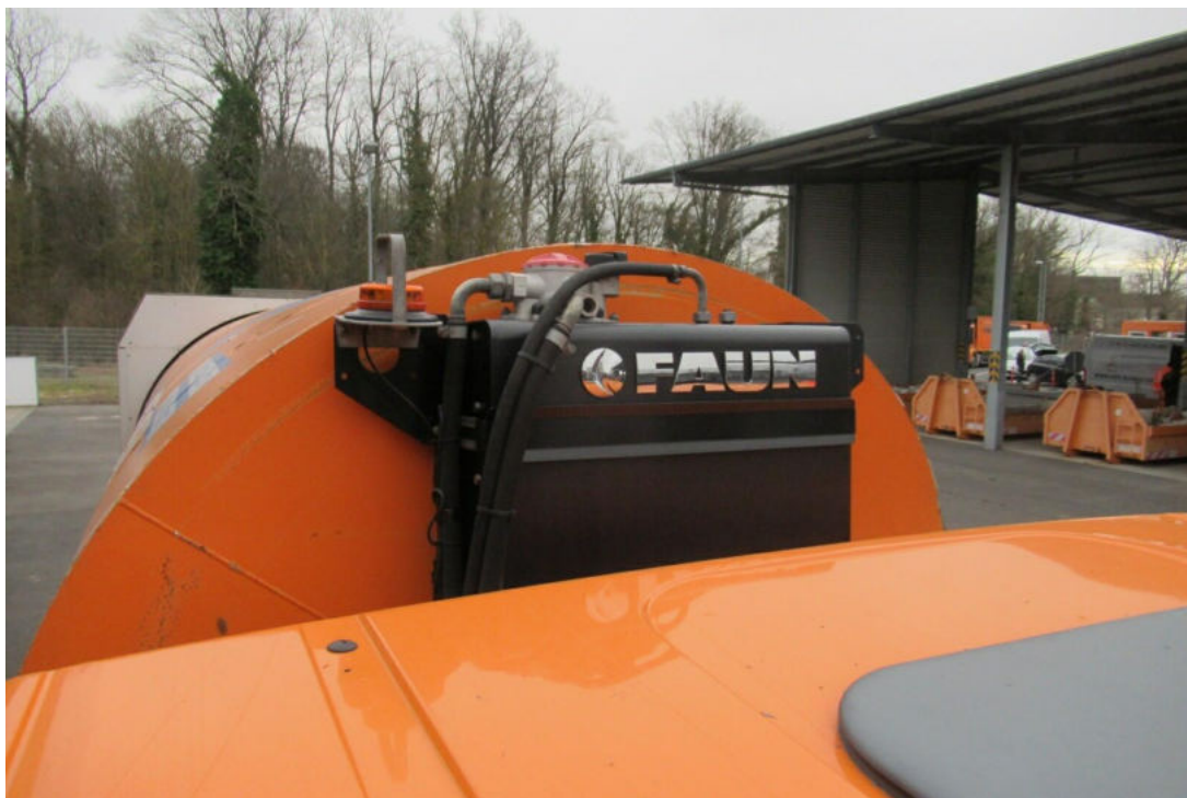
Bild 12 : Hydraulikbehälter im Schadenbereich / verzogen
