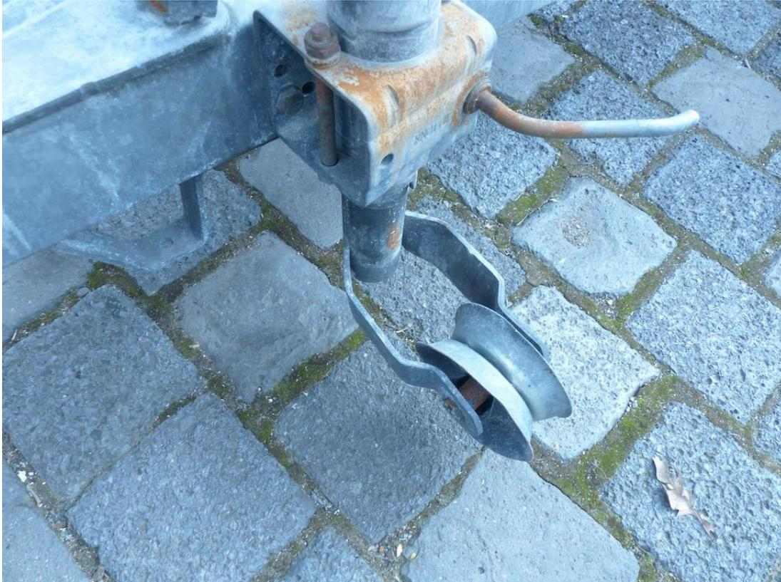
Bild 5, linke Seite mit beschädigtem Buglaufgrad
